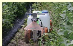
ラジコン式 薬剤散布ロボット「ウネマキ」
