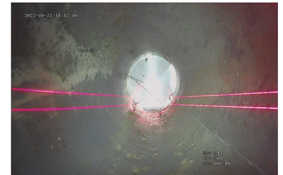
φ200の管内試験の実際の視点写真実際
