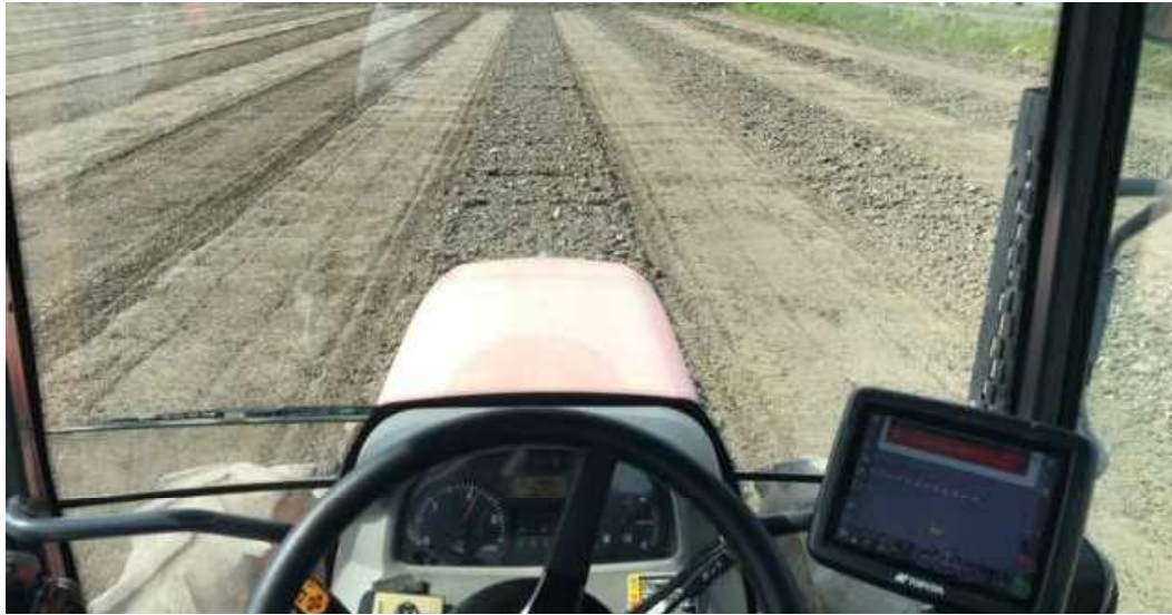
自動操舵による作業（昼間）
